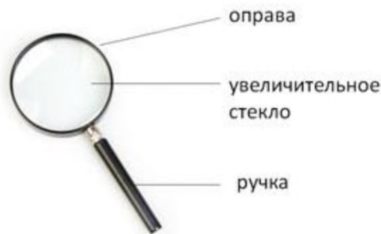
Рис. 1. Строение ручной лупы
